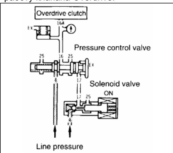
Когда соленоид включен, шариковый клапан соленоида закрыт, и давление жидкости не попадает в магистраль №17. Под действием пружины управляющий клапан перемещается вправо, тем самым, перекрывая запитку муфты OD, одновременно открывая магистраль №16 на сливе в магистраль №25.
