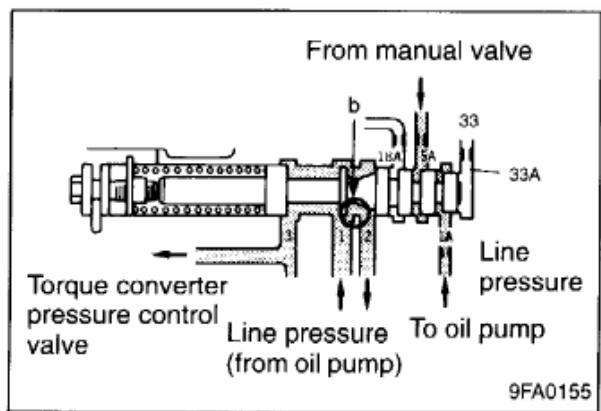
Если давление продолжает повышаться, клапан переместиться еще левее и откроется сечение **b** в порт №2, через которое откроется слив жидкости в картер трансмиссии, что приведёт к понижению давления в линии, т. е. в портах №1А, 5А и 33А. Клапан, под действием пружины, сместится правее, прикрывая сечение **b**, ограничивая слив через порт №2.
