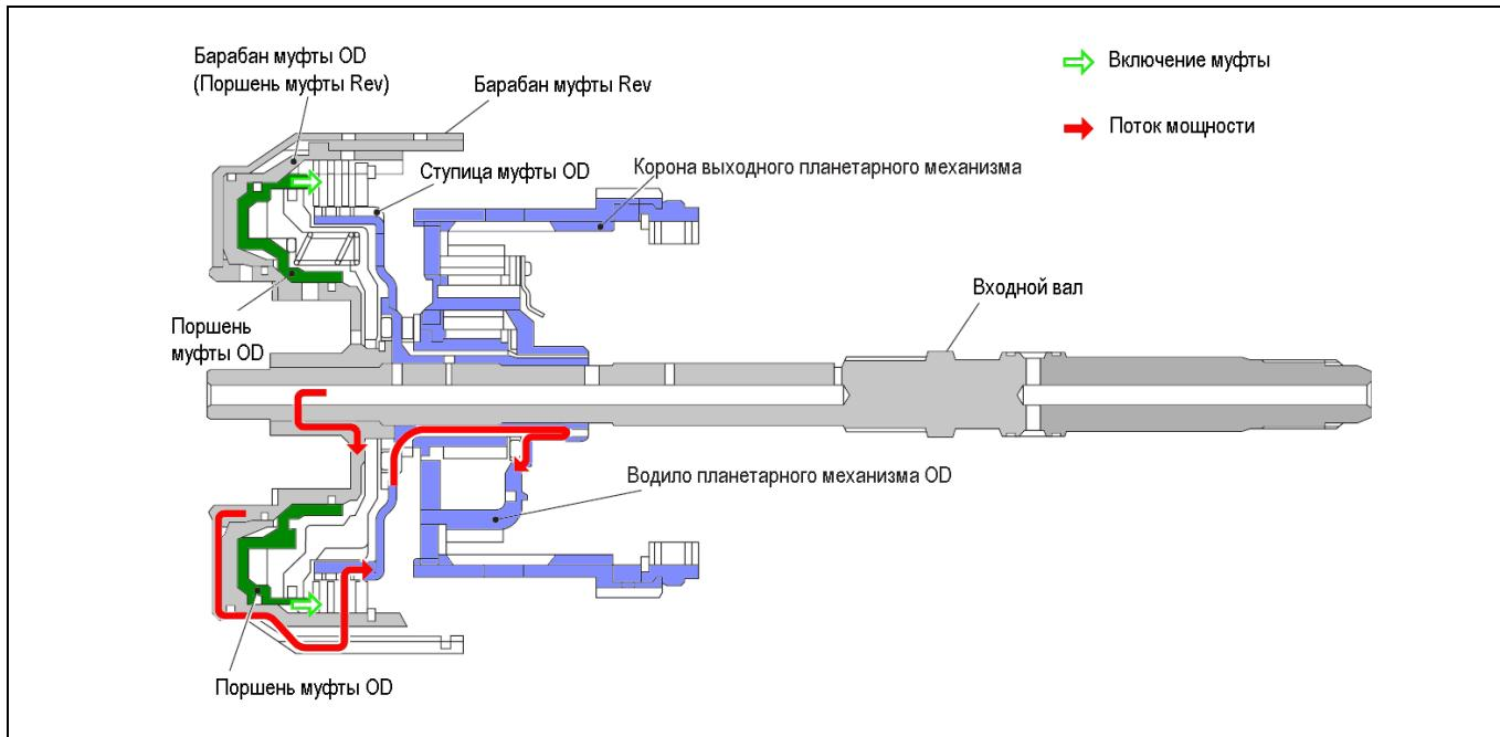
Муфта Overdrive работает на 3-й и 4-й передачах, передавая крутящий момент с входного вала на водило ПМ Overdrive и корону выходного ПМ.
