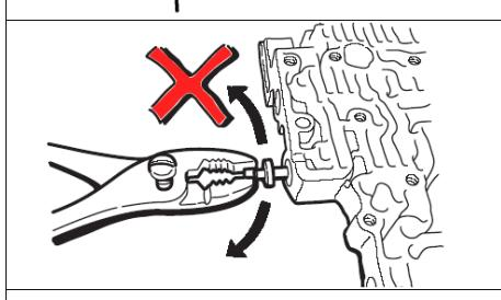
При ремонте гидравлического блока клапанов нельзя применять инструмент. Плунжеры должны извлекаться и устанавливаться под собственным весом. В случае заклинивания клапанов следует заменить гидравлический блок клапанов в сборе.
