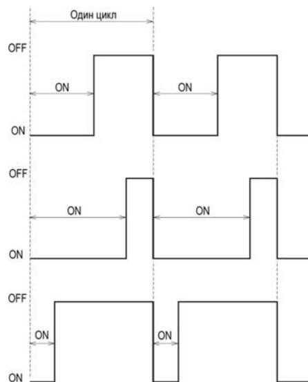
Данный параметр по каждому соленоиду можно проконтролировать по Data List в MUT-III. При этом значение 100% соответствует включенному соленоиду и выключенной муфте (или тормозу). А 0% соответствует выключенному соленоиду и включенной муфте (тормозу).
