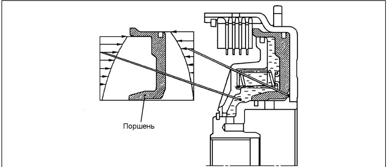
На высоких оборотах двигателя может возникнуть эффект, который затруднит выключение муфты, т. к. давление жидкости в камере между поршнем и барабаном будет поддерживаться за счёт центробежного эффекта, и усилия возвратной пружины может оказаться недостаточно для быстрого выключения муфты.
