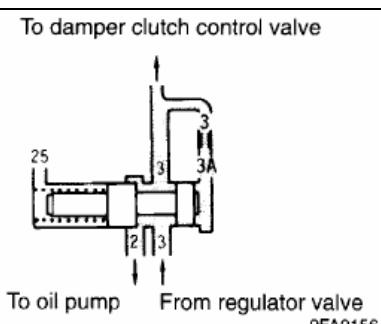
Когда давление, действующее на торец клапана против действия пружины, повышается настолько, что перемещает клапан влево, открывается порт №2 на сливе, тем самым, понижая давление в гидротрансформаторе до установленного уровня. Таким образом, происходит регулировка давления.
