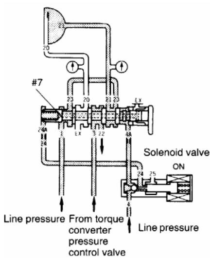
Таким образом, блокировка гидротрансформатора будет выключена. Когда приходит время включить блокировку гидротрансформатора, электронный блок управления посыпает широтно-импульсный сигнал на управляющий соленоид. В результате чего давление в магистрали №24 и с левого торца клапана начнёт уменьшаться, и клапан переместится влево. Теперь жидкость из магистрали №3 попадёт в магистраль №22 и, затем, в радиатор, а не в гидротрансформатор. В тоже время, жидкость из магистрали
