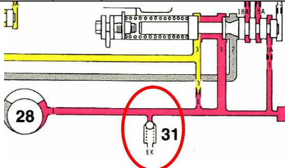
Гидравлическая магистраль №1 содержит предохранительный клапан, который открывается тогда, когда давление жидкости на выходе из насоса поднимается настолько высоко, что клапан регулятора давления не способен снизить его до требуемого уровня. Пружина клапана сжимается и предохранительный клапан открывает слив ATF в картер, что снижает давление, поступающее к регулятору.
