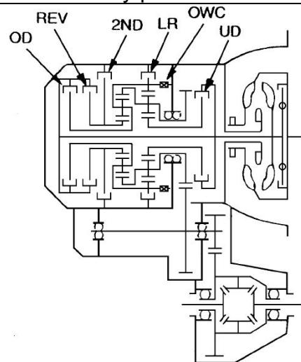
Трансмиссия состоит из гидротрансформатора и коробки передач.
