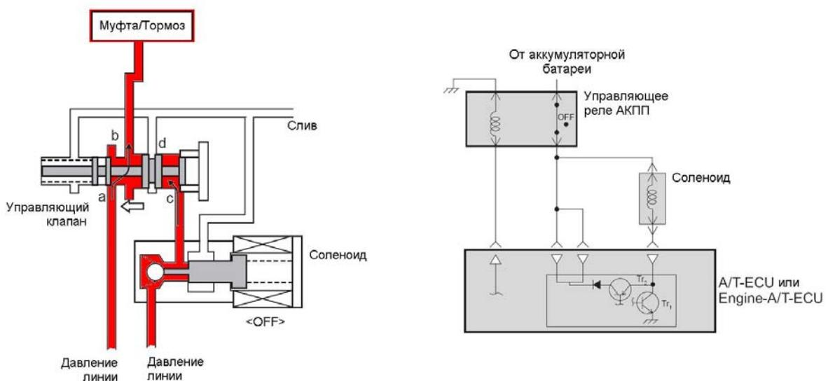
Например, если соленоид UD обесточен, то давление ATF поступает к плунжеру управляющего клапана и перемещает его влево (см. рисунок), что
