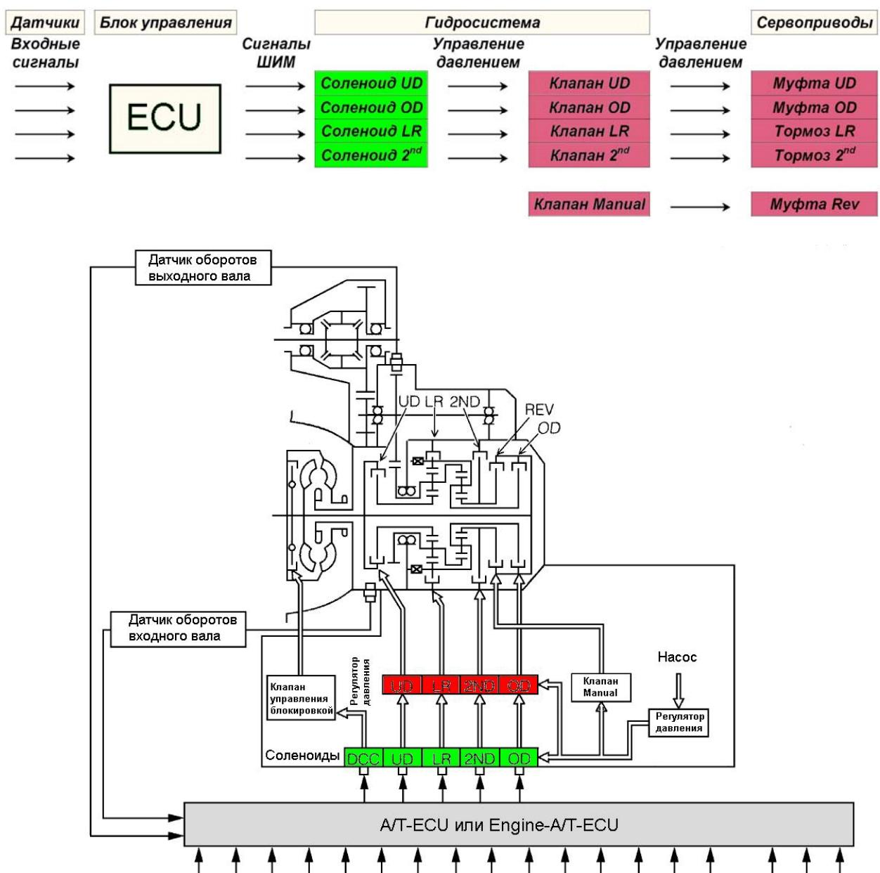
Управление давлением жидкости, в сервоприводах муфт и тормозов, осуществляется независимо соответствующими соленоидами, что позволяет добиться максимальной гибкости управления трансмиссией.
