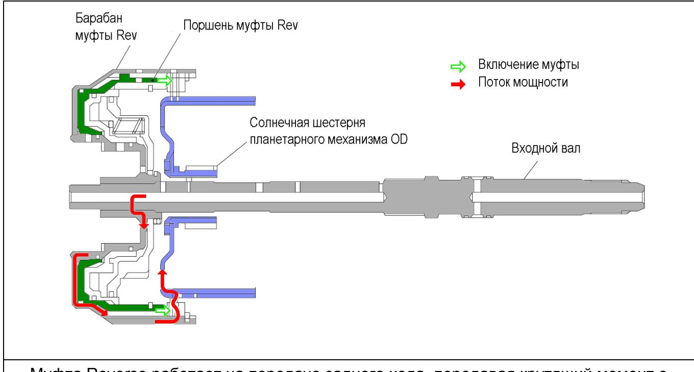
Муфта Reverse работает на передаче заднего хода, передавая крутящий момент с входного вала на солнечное колесо ПМ Overdrive.
