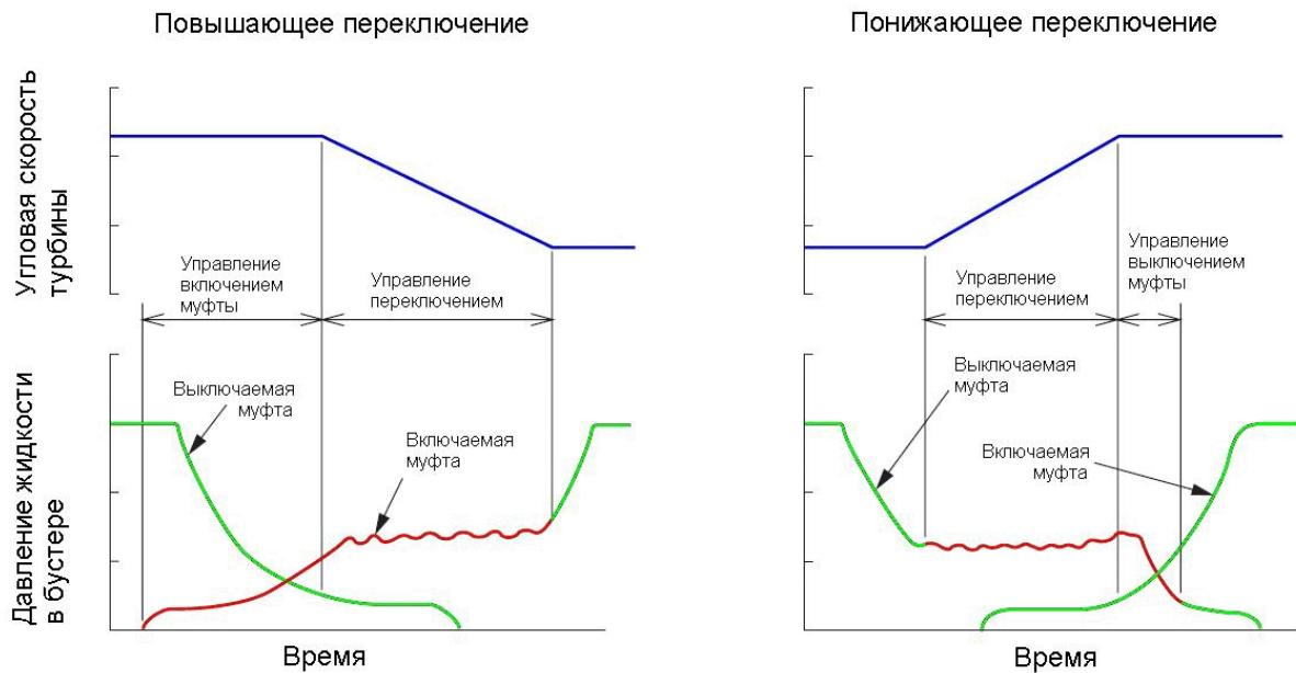
Для обеспечения контроля давлений в сервоприводах во время переключения передач, управление соленоидами в этот момент осуществляется сигналами широтно-импульсной модуляции. После завершения переключения передач широтно-импульсное управление прекращается.
