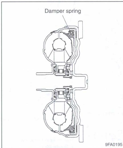
Используемый гидротрансформатор имеет аналогичную конструкцию, трансмиссии серии F4A2.
