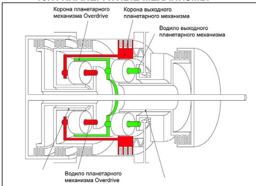
Трансмиссия содержит комбинацию из двух планетарных механизмов. Водило ПМ Overdrive механически связано с короной выходного ПМ. И наоборот: водило выходного ПМ – есть корона ПМ Overdrive.
