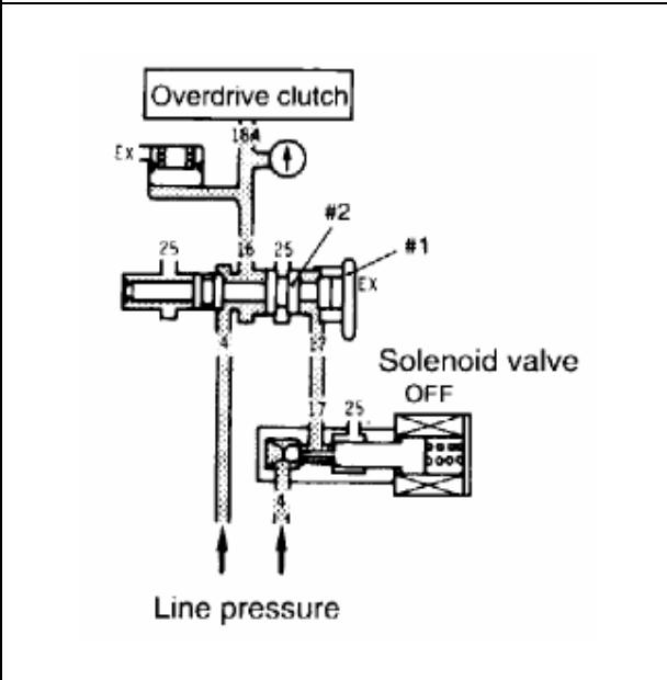
Когда приходит время включить муфту OD, на соленоид начинает подаваться широтно-импульсный сигнал таким образом, что якорь электромагнита начинает постепенно открывать шариковый клапан, плавно поднимая тем самым давление в магистрали №17. Поясок #2 управляющего клапана больше чем #1, поэтому результирующая сила будет направлена влево против действия пружины. Когда клапан переместится влево, сжав пружину под действием давления в магистрали №17, давление
