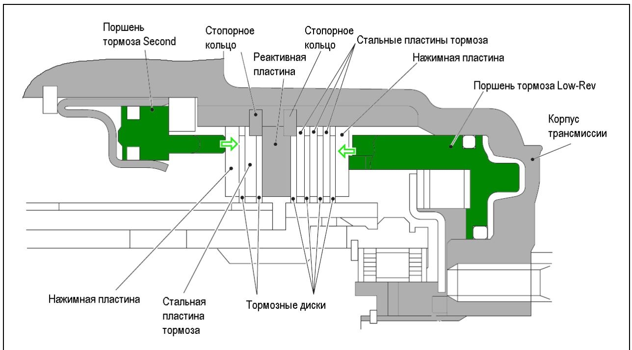
Конструкция обоих тормозов показана на рисунке. Многодисковые фрикционные пакеты расположены с двух сторон от реактивной (упорной) пластины (reaction plate). Реактивная пластина фиксируются в корпусе трансмиссии стопорными кольцами практически без зазора. Тормозные диски тормоза Second входят в зацепление с солнечной шестерней ПМ Overdrive, а тормоза Low-Rev – с коронной шестерней выходного ПМ. Стальные диски фрикционных пакетов тормозов входят в зацепление с корпусом трансмиссии.
