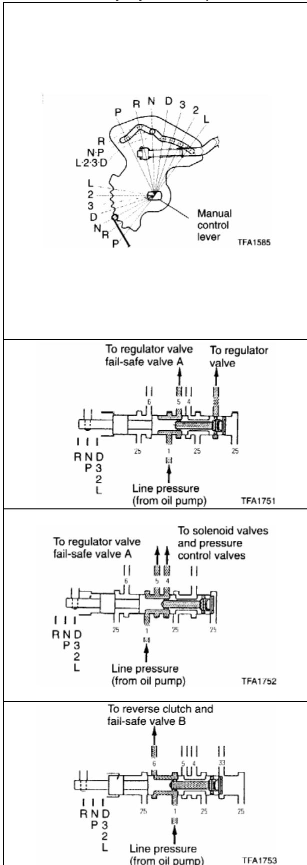
Клапан выбора режима отслеживает перемещение рукоятки селектора выбора режима, расположенного в салоне автомобиля, и соединяет каналы гидросистемы в соответствии с выбранным режимом.
