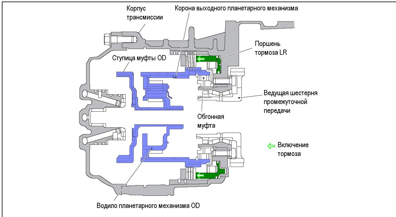
Тормоз Low-Reverse работает на 1-й передаче и на передаче заднего хода, а также в положениях селектора «P» и «N», останавливая корону выходного ПМ и водило ПМ Overdrive.
