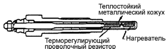
"Металлическая" свеча накаливания
