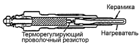
"Керамическая" свеча накаливания
