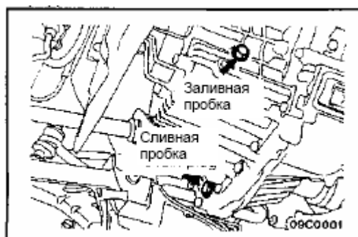
Рис. 8-6 Проверка уровня масла в коробке передач
