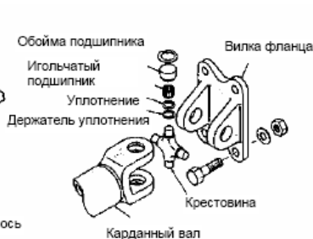
Рис. 4-5 Устройство карданного шарнира неравных угловых скоростей
