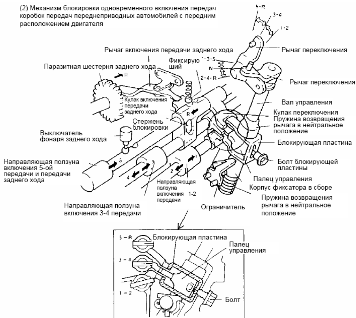
Рис. 3-13 Механизм блокировки одновременного включения передач
