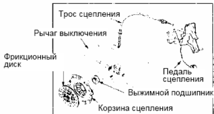
Рис. 2-8 Дисковое сухое сцепление
