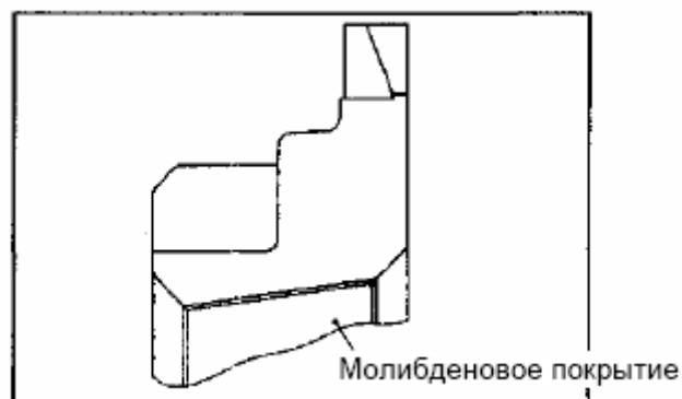
Рис. 3-20 Кольцо синхронизатора с молибденовым покрытием
