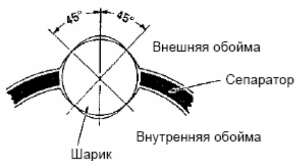
Рис. 5-8 Взаимодействие шариков, внешней и внутренней обоймы
