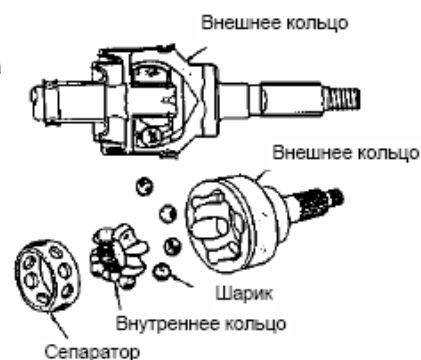
Рис. 4-6 Шариковый шарнир равных угловых скоростей
