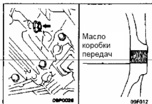
Рис. 8-6 Проверка уровня масла в коробке передач
